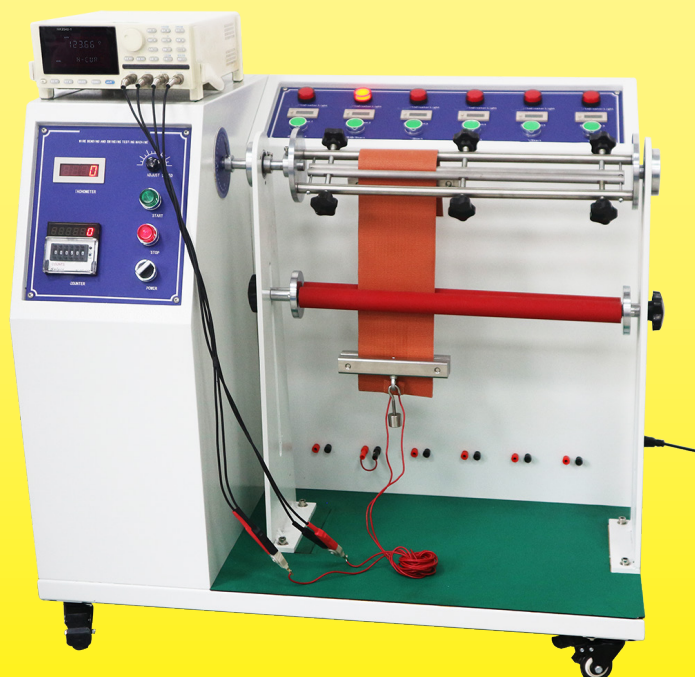
Calentador de silicona flexible durante la prueba de flexión
