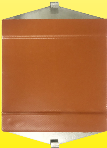
Muestra de prueba de fuerza de desgarro
