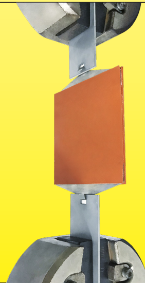
Equipo de prueba de fuerza de desgarro
